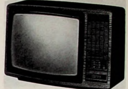
Marke: Grundig Modellname: Super Color 7400 Erstlieferung a. d. Handel: Mai 76 Endverkaufspreis: liegt bei 2100 DM Bilddiagonale: 66 cm Fernbedienung: Infrarot Gehäuseausführung: Nußbaumfarben, Weiß Uhrzeit-Anzeige: nein
