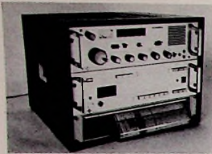
Bild 15. Programmierbare Frequenzband-Überwachungsanlage AFR 1500 (AEG-Telefunken)
