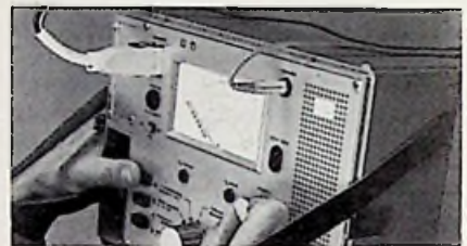
Die eindeutig vorwählbare Meßschaltung gestattet einfache und übersichtliche Bedienung des Programat 0100 von Gossen
