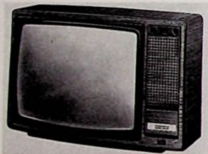
Marke: Grundig Modellname: Super Color 8600 Erstlieferung a. d. Handel: Mai 76 Endverkaufspreis: liegt bei 2400 DM Bilddiagonale: 66 cm Fernbedienung: Infrarot Gehäuseausführung: Nußbaumfarben, Weiß Uhrzeit-Anzeige: nein
