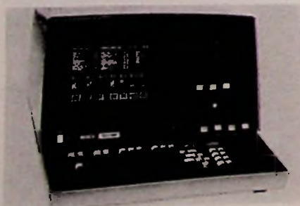
Bild 16. Datensichtgerät mit Eingabetastatur für die Funkleitstelle bei Funknetzen mit digitaler Datenübertragung (Bosch)
